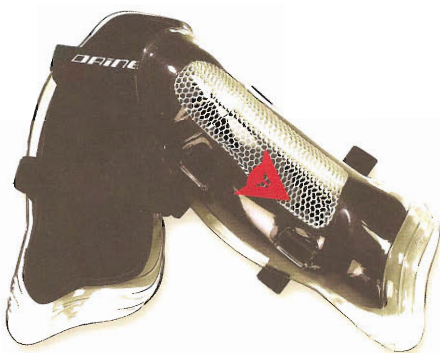
Parastinchi modello D.Shinguard Plus, con guscio esterno in polycarbonato, protezione per ginocchio e tibia con rinforzo in honey-comb di alluminio, inserti morbidi a densità differenziata, doppio strap di fissaggio. The D.Shinguard Plus model, with outer shell in polycarbonate, knee and shin protection with aluminium honeycomb reinforcement, soft inserts in variable-density foam, double fastener strap.
