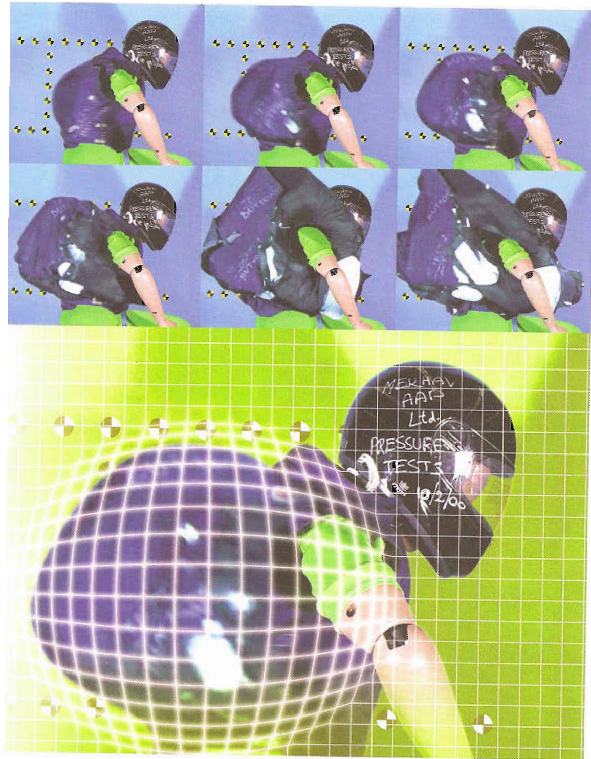
Sequenza di gonfiaggio del primo prototipo D.Air. Inflation sequence of the first D.Air prototype.
