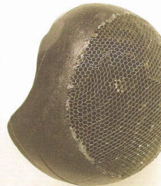
A sinistra: scarichi posteriori per il sistema di ventilazione del casco Airstream; a destra: sperimentazione di materiali alternativi e traspiranti per le calotte interne dei caschi. Left: rear ducts for the ventilation system of the Airstream helmet; right: experimentation with alternative, breathing materials for the internal liners of the helmets.
