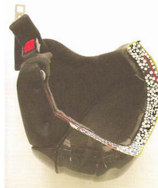
A sinistra: spaccato di un casco da sci co-stampato con guscio interno in TAU (polistirolo espanso + poliuretano espanso); a destra: casco D.Set. Left: dissection of a ski helmet, co-moulded with internal shell in TAU (expanded polystyrene + expanded polyurethane); right: D.Set helmet.
